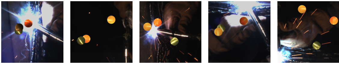
Obrázek 5: Ukázky synteticky generovaných trénovacích snímků ( 350 \times 350 px). Markery jsou kompozitovány na reálné pozadí se svařovacím obloukem.
